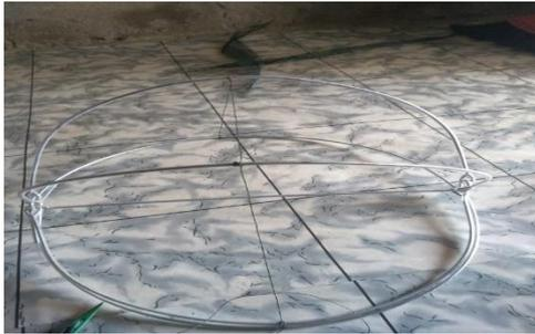
Gambar 4. Pembentukan rangka bawah dan atas
