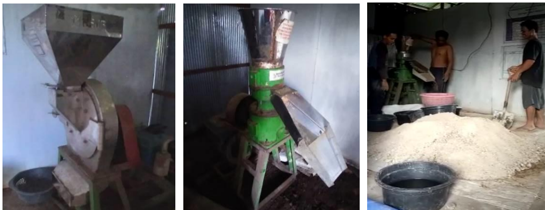
Gambar 6. Mesin penghalus (a); mesin pellet (b), dan proses mencetak pakan ikan (c)
