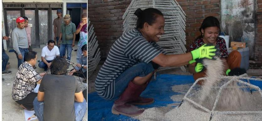
Gambar 3. Proses pelapisan rangka besi dengan pasir
